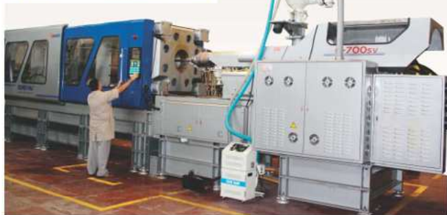
Inyectora. Para plásticos con horno secador, capacidad 4.000 gramos.
