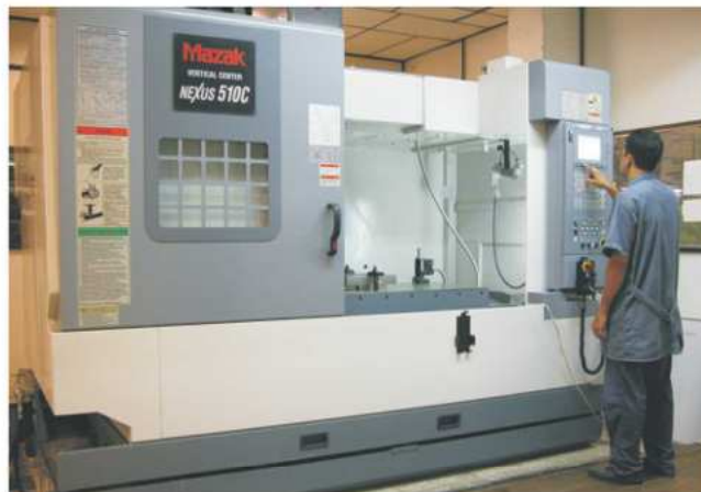
Centro de Mecanizado Optimiza la producción de moldes por medio de un magazín de 30 herramientas controladas por un PC fusionado en un CNC. Con refrigeración interna en el husillo y unas velocidades de avance de 33m /minuto.
