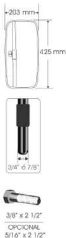
2-169L Espejo plástico. Con luz direccional.
