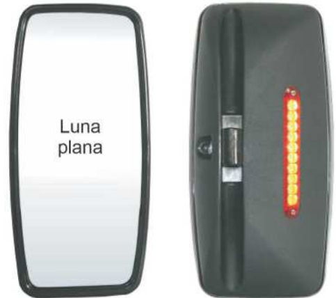
2-167L Espejo plástico. Con luz direccional
