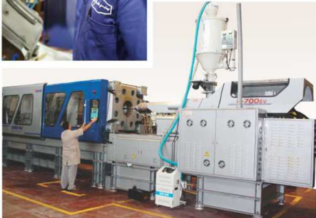
Inyectora. Para plásticos con horno secador, capacidad 4.000 gramos.
