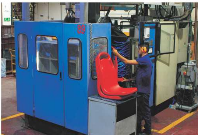
Sopladora. Optimiza el proceso de soplado, especial para asientos para transporte masivo.
